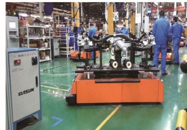
应用于烟台汇众现场 AGVs applied in Yantai Huizhong Co., Ltd.
