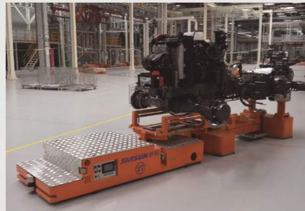
爱科(常州)农业机械有限公司现场 Inductive Power Transfer AGVs applied in AGCO(Changzhou)
