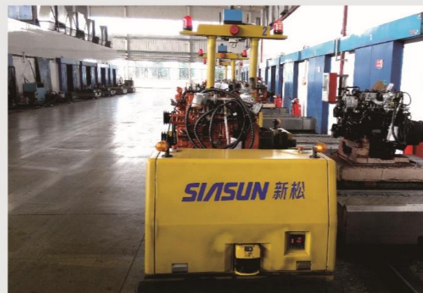
应用于广西玉柴动力公司现场 AGVs applied in Guangxi YUCHAI Power Machinery CO.,LTD
