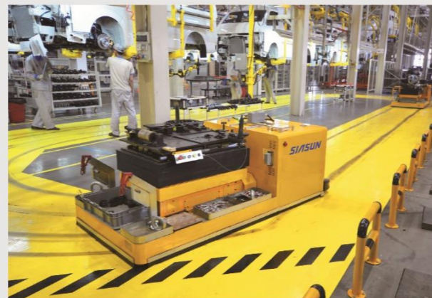
金杯汽车现场 AGVs applied in Shenyng Brilliance Jinbei Automobile Co.,Ltd.
