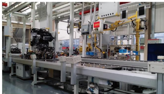
发动机数字化装配线 | Engine digital assembly line
